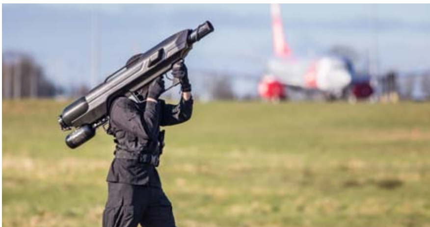
Das Abwehrsystem „SkyWall 100“ schießt ein Fangnetz auf Drohnen.
