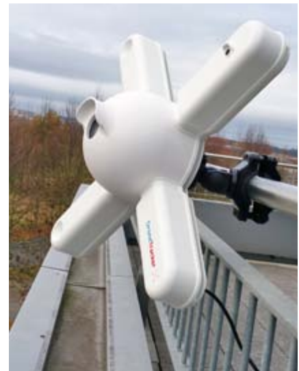
Der Allround-Sensor „DroneTracker“ kann an Fassaden, Geländern und Stativen befestigt werden.
