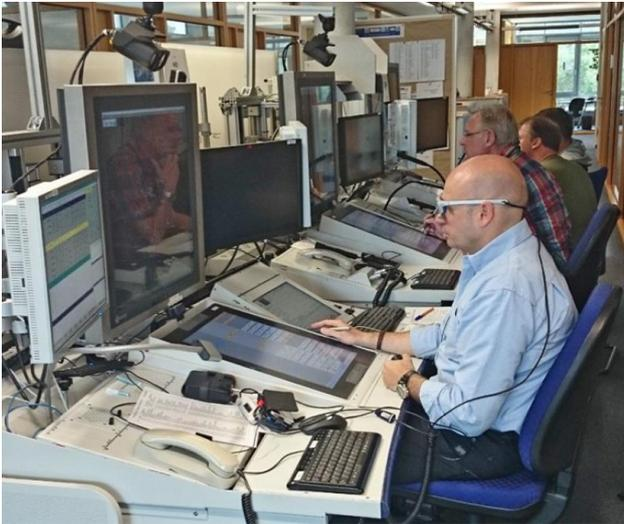
Abb. 1: Versuchsdurchführung an einem experimentellen Lotsenarbeitsplatz im DFS-Forschungszentrum. Links und rechts über dem quadratischen Hauptbildschirm in der Mitte sind die Kameras zur Posen- und Mimikerkennung zu sehen. Der Proband trägt eine Brille zur Erfassung der Blickrichtung und des Pupillendurchmessers.
