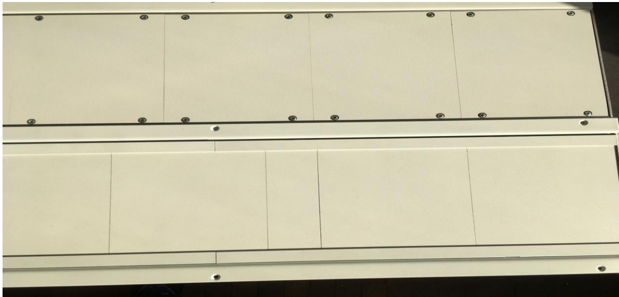
Abbildung 11: Vergleich alter BGT mit Schraubverbindung zu neuem BGT mit Spannsystem.
