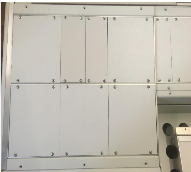
Abbildung 3: Beispiel eines aktuell verbauten Baugruppenträgers mit verschraubten Blindplatten in einer Musterkonsole.
