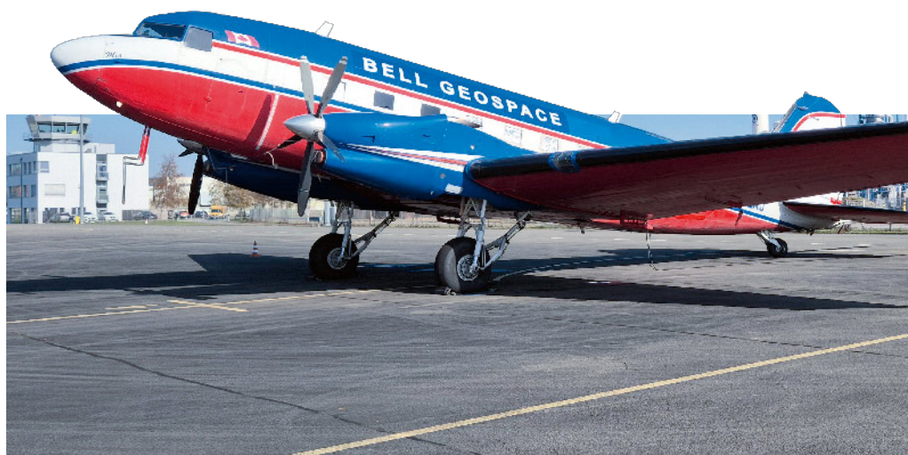
Diese in Speyer stationierte BT-67 ist eine modifizierte Version einer Douglas DC-3 und wird vom britischen Unternehmen Bell Geospace für geologische Dienste eingesetzt.
