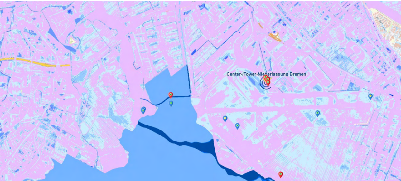
In einem DFS-eigenen Tool können für jeden einzelnen DFS-Standort relevante Klimarisiken dargestellt werden - hier beispielhaft die Gefahr durch Überflutung am Standort Bremen. (Foto: DFS)
