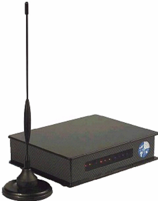
Abb. 1: SBS-1 ADS-B Empfänger
