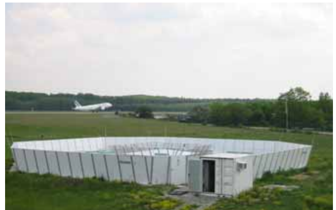
Abbildung 1: Messfeld auf dem Flughafen Frankfurt. Im Vordergrund der Messcontainer mit der EDV vor den akustischen Quellen und dem Radar innerhalb des Schallschutzauns. Im Hintergrund ist ein Abflug auf der Startbahn 18 zu sehen.
